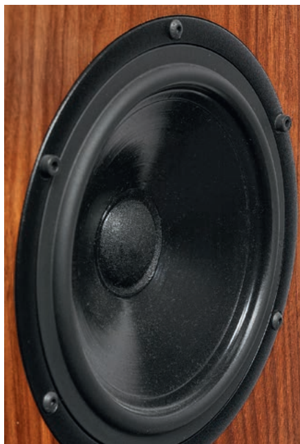
Głośnik nisko-średniotonowy ma celulozową membranę i nakładkę przeciwpyłową o niewielkiej średnicy, związaną z 26-mm cewką drgającą.
