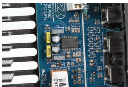
Scalona drabinka rezystorowa marki JRC w sekcji przedwzmacniacza, obok niej selektor wejść na hermetycznych przełącznikach.
