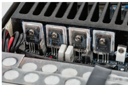
Końcówka mocy, złożona z elementów firmy Sanken, pracuje w nietypowej klasie G.
