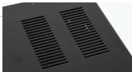
W górnej ścianie przygotowano dwa otwory wentylacyjne, potrzebne w lampowej wersji 100t.
