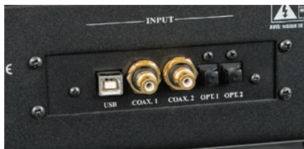
„Okienko” przygotowano do wkręcenia gotowego modułu wejść cyfrowych i układu konwertera.
