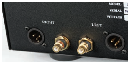
We wszystkich trzech testowanych przetwornikach dostępne są wyjścia zarówno w standardzie RCA, jak i XLR
